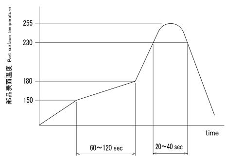
プリヒート Preheat 温度 Temperature 150~180℃、時間 Time 60~120 秒 sec. ピーク Peak 温度 Temperature 255℃ (230℃以上、20~40 秒)
