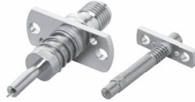
主として生産工程での検査に用います。プローブを測定設備に組み込み、測定中はコネクタに押し付けて使用します。爪による嵌合機能を持たないため、被測定物のコネクタにダメージを与えません。プローブに被測定物のコネクタの位置ずれを吸収するためのフローティング機構を組み込んであるため、測定設備にフローティング機構は不要です。
