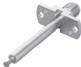
主として生産設備での検査に用います。自動測定用プローブ（フローティング機構有り）と機能は同じです。このプローブは接続した測定用ケーブルのテンション（張力）の影響を受けないための特殊な機構を内蔵しているため、測定設備内でのケーブルの引き回しが容易です。
