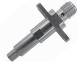
主として生産工程での検査に用います。プローブを測定設備に組み込み、測定中はコネクタに押し付けて使用します。爪による嵌合機能を持たないため、被測定物のコネクタにダメージを与えません。当プローブは被測定物のコネクタの位置ずれを吸収するためのフローティング機構を持たないため、測定設備にフローティング機構を持つ必要があります。
