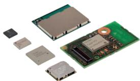
通信模块是以无线的方式连接各类设备时不可或缺的复合元件。可搭载于我们生活中随处可见的智能手机、平板电脑、数码相机和空调等家电,以及汽车导航仪等车载设备中。此外还可用于下载或上传照片和音乐,或者用于在汽车内免提拨打电话等,通信模块在方方面面发挥着作用。
