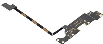
多层LCP产品，是用LCP（液晶聚合体）薄片堆叠而成的树脂多层基板。它具有优异的高频特性，可通过低吸水性实现性能稳定的基板，同时由于不需要连接层，所以为薄型，也可以进行复杂的弯曲加工。运用村田的全层一次性叠层技术还可实现更多层，能够进行高自由度的设计。被应用于智能手机和可穿戴设备等，为设备的小型化、薄型化、高性能化、低功耗化做出了贡献。
