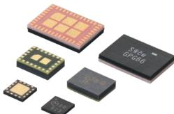
高频模块是电子元件组件,通过将各种重要装置集成到小型封装结构中,实现对无线设备的通信进行管理的模拟高频电路。该模块由表面波滤波器等无源设备、发送时的高输出放大器(PA)、接收时的低失真放大器(LNA)以及天线切换开关等半导体装置组成,被广泛应用于智能手机、平板电脑等各种无线设备中。
