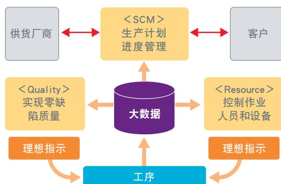
该生产管理体系有三大功能。首先是供应链管理 (SCM) 功能, 该功能根据来自客户的订单信息制定生产计划, 并将其与回复交货期和从供应商处订购材料关联起来。其次是根据生产计划进行实际生产, 并基于生产信息 (大数据), 以实现零缺陷 (不良率为零) 为目标提供关于制造条件和改善的指示的功能。最后是监测作业人员和设备等资源的工作状态, 并提供关于资源增减、生产顺序等的指示的功能。充分利用这些功能, 满足越来越高度化、多样化的客户要求。
