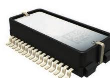
陀螺仪加速度复合式传感器
