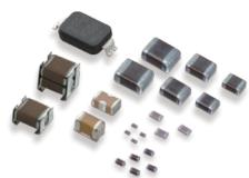
MLCC除了临时蓄电或放电,或吸收信号中含有的噪声并提取一定频率的信号之外,还具备能切断直流电,仅使交流电流通等功能,被广泛应用于移动设备、家电产品,以及物联网设备等中。此外,还被应用于汽车、医疗和太空设备等要求高可靠性的用途。
