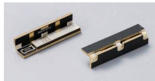
开发搭载NXP公司IC的超小<sup>\*</sup>UWB通信模块
