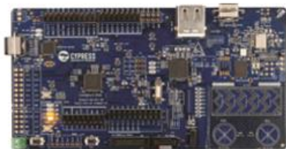
CY8CKIT-062-WiFi-BT PSoC™ 62 MCU (1 MB Flash, 288 KB SRAM), AIROC™ CYW4343W Murata 1DX module
