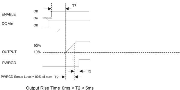
PWRGD Delay 0ms < T3 < 10ms ENABLE-TO-OUTPUT DELAY0ms < T7 < 100ms
