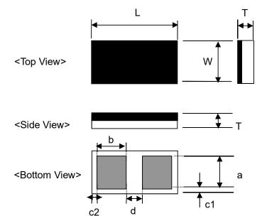
Unit:mm Mark **Dimensions** Mark **Dimensions** L 2.00±0.15 b 0.6±0.1 W 1.20±0.15 с1 0.2±0.2 Τ 0.5MAX c2  $0.2 \pm 0.2$ 0.85±0.10 d  $0.4 \pm 0.1$ а
