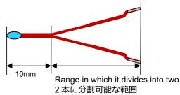
5. 樹脂部に強い押圧をかけると素子が割れたり欠けたりします。加工時に 30 N 以上の圧力(常温)をかけない で下さい。使用時では、加圧された状態でのご使用は避けてください。
