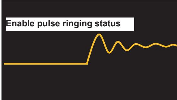
&lt;誤動作の原因となるEnableのリングング例&gt; &lt;Example of Enable pulse ringing that causes malfunction&gt;
