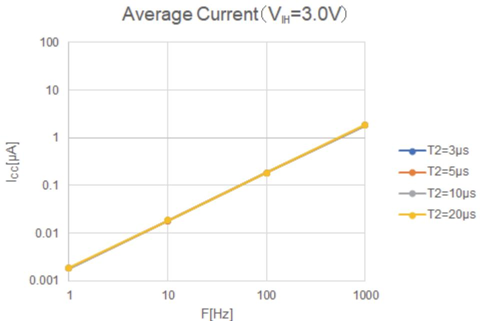
※ :  $V_{IH}=3.0V$ の時の平均消費電流 $I_{CC}$ は以下のように求めます。
