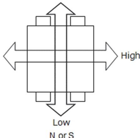
注1) センサにかかる磁界の向きと、センサの検出磁界方向を合わせて設計下さい。
