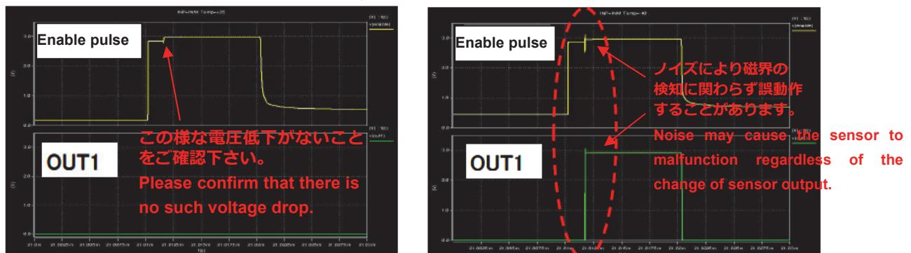
&lt;イネーブル波形のノイズとOUT1の誤動作状態&gt; &lt;Enable pulse waveform noise and malfunction of OUT1&gt;
